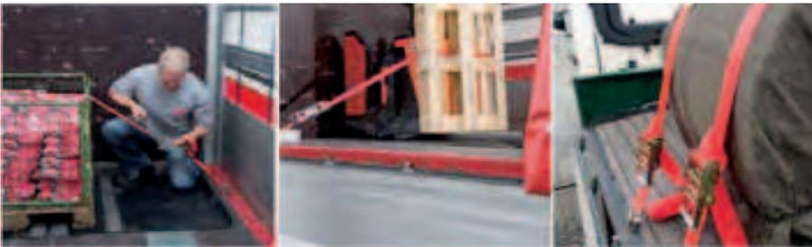
**Amarra plana de alta resistencia para la fijación de la carga durante el transporte**
